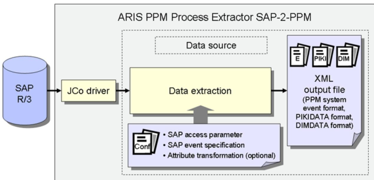
Mit Hilfe des Java Connector-Treibers (JCo) wird über die Zugangsdaten der R/3-Systemkonfiguration eine Verbindung zum SAP R/3-System hergestellt. Anschließend werden Daten aus den Tabellen des R/3-Systems mit der R/3-Tabellenkonfiguration und einer optionalen Attributtransformation über das Modul **Datenextraktion** (Seite 4) ausgelesen und in XML-Dateien eines PPM-konformen Ausgabeformates geschrieben.
