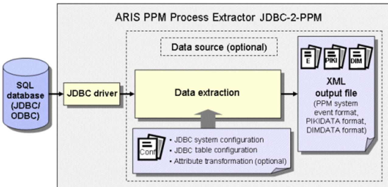
Mit Hilfe des JDBC-Treibers wird über die Zugangsdaten der JDBC-Systemkonfiguration eine Verbindung zur SQL-Quelldatenbank hergestellt. Anschließend werden Daten aus den Tabellen des Quelldatenbanksystems mit der JDBC-Tabellenkonfiguration und einer optionalen Attributtransformation über das Modul **Datenextraktion** (Seite 4) ausgelesen und in eine XML-Datei eines PPM-konformen Ausgabeformates geschrieben.
