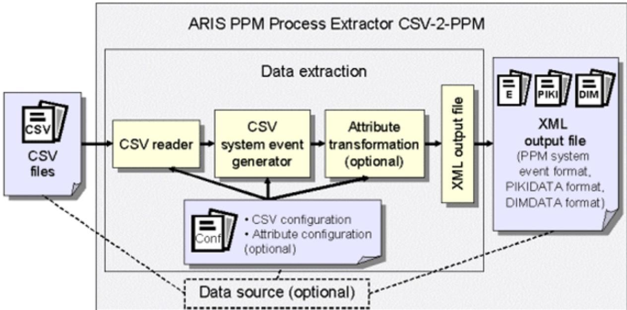
Die CSV-Dateien werden mit Hilfe des CSV-Reader unter Verwendung der CSV-Konfiguration gelesen. Der CSV-System-Event-Generator und ggf. die Attributtransformation überführen die ausgelesenen Informationen wahlweise in das PPM-System-Event-Format, das PIKIDATA- oder das DIMDATA-Format. Die XML-Ausgabe schreibt die gelesenen Daten in die entsprechende XML-Ausgabedatei.
