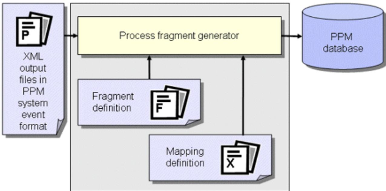
In einem weiteren Arbeitsschritt werden die in die Datenbank eingelesenen Fragmentinstanzen durch das PPM-Kommando **runppmimport** zu Prozessinstanzen zusammengesetzt und Prozesstypen zugeordnet. Nach der Kennzahlenberechnung stehen die Prozessinstanzen für ausführliche Analysen bereit.
